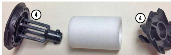
7. Colocar el nuevo elemento filtrante de aire en los conectores plásticos. Gire ligeramente los conectores de plástico hasta que encajen, aproximadamente 1/4 de vuelta.
