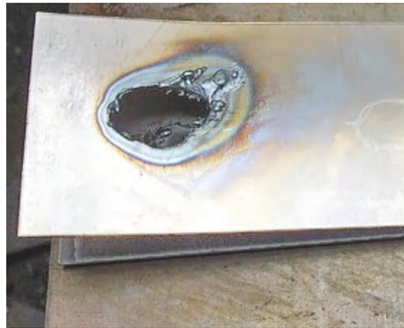
**Soldadura por puntos en la placa inferior**
